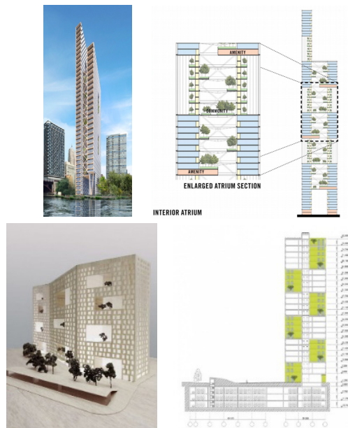
Рис. 6. Проекты жилых комплексов с атриумными пространствами: а-б) ЖК River Beech для Чикаго: внешний вид и разрез здания [12], США. Компания Perkins + Will; в-г) ЖК «Лайм», Москва, Россия. Арх. бюро ADM, 2021г.: макет и разрез, секция 4 [13]
